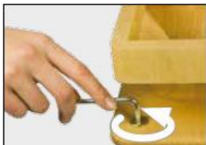
Рис. 1: Шестигранным ключом открутите четыре латунных винта
