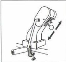
Ослабьте гайку-«барашек» с правой стороны зернодавилки. Для толстых хлопьев передвиньте деревянную ручку вверх. Для тонких хлопьев передвиньте деревянную ручку вниз. Зажмите гайку-«барашек».
