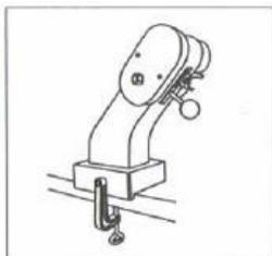
Специальным креплением, входящим в комплект поставки, закрепите зернодавилку на краю стола. Крепко затяните зажимы так, чтобы зернодавилка твёрдо и без колебаний стояла на столе.
