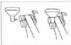
Возьмите воронку в узком месте и вставьте металлический стержень в отверстие с резиновым уплотнением. При необходимости используйте смазку (например жир или вазелин).
