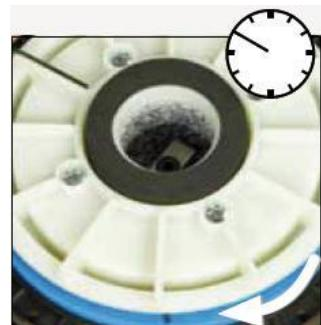
Рис. 6 Слегка надавите камень сверху и прокрутите один полный оборот, а затем ещё до «10 часов» вплоть до его остановки.
