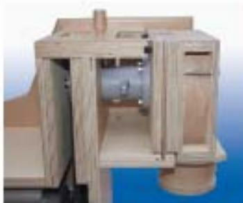
В любой момент, быстро и просто, можно открыть и почистить камеру помола. Шестигранный ключ, входит в комплект поставки. В случае обслуживания мельницы камера помола легко снимается полностью. Просто снимите ремень привода и вытащите камеру помола.
